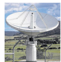
Radioteleskop mit 12 m Durchmesser in Tasmanien. Bild: SN/TU WIEN
